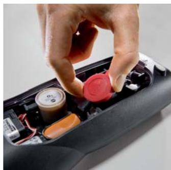
Пользователь может выполнить замену сенсора или выбрать дополнительный параметр измерения непосредственно по месту замера...
