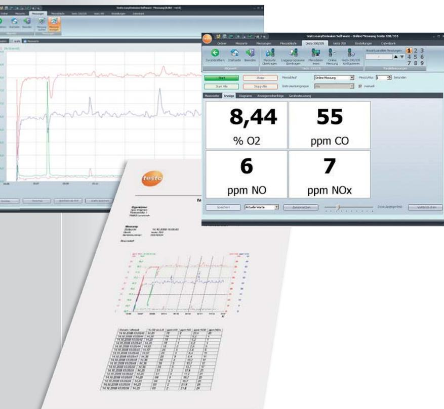
С помощью пакета ПО "easyEmission" Вы можете считывать, редактировать, сортировать по файлам и управлять данными измерений:
