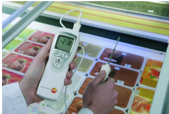
Измерение температуры воздуха на охлаждающих прилавках и в морозильниках
